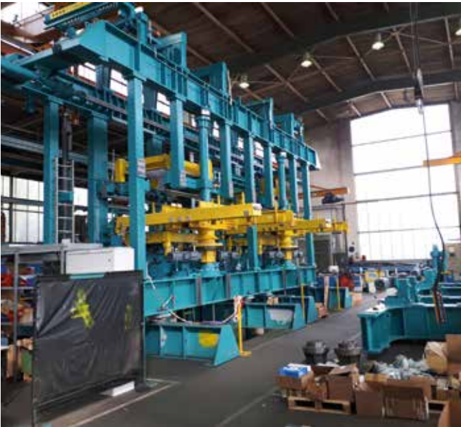
Nelcast Dökümhanesi, Hindistan için üretilen hat 2100 x 1200 x 400 + 50/400 derece ölçüleri ve saatte 60 kalıp
